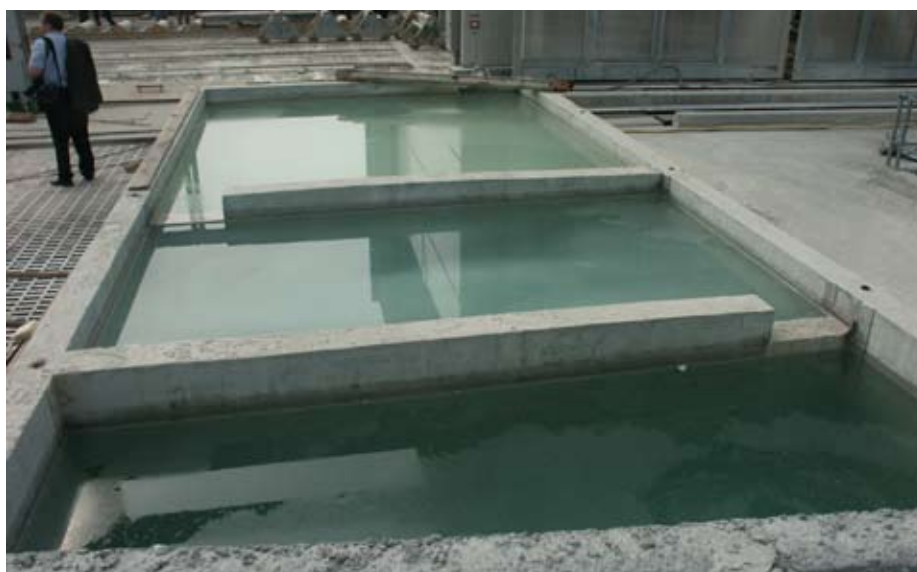
Nell'industria del calcestruzzo i materiali solidi contenuti nell'acqua di processo vengono estratti in modo tale che l'acqua possa essere riciclata per la produzione di calcestruzzo. Per gentile concessione di Precompressi Centro Nord, Verona.
